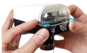
FORO COMANDO MANUALE / MANUAL OVERRIDE HOLE
